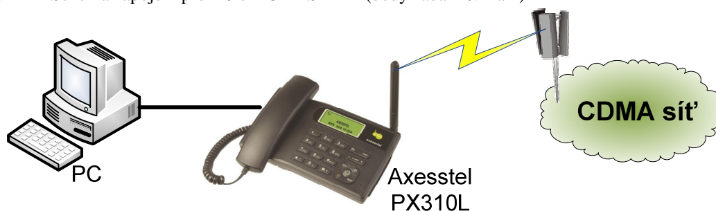
Obr. 3.2 Schéma zpojení pro měření CDMA (bod zadání č. 3 – neměřilo se)
