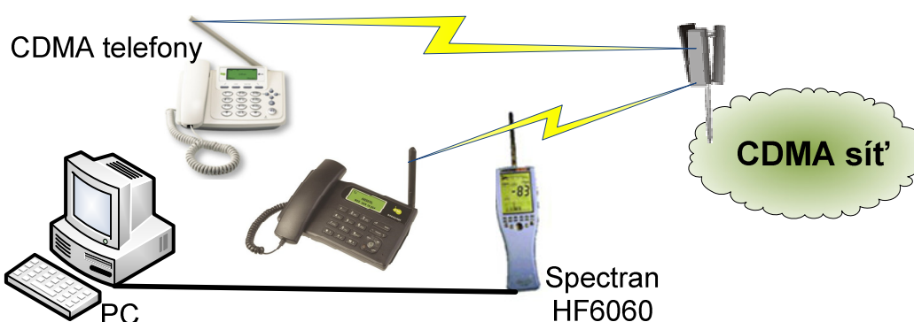
Obr. 3.2 Schéma zpojení pro měření CDMA (bod zadání č. 3 – neměřilo se)
